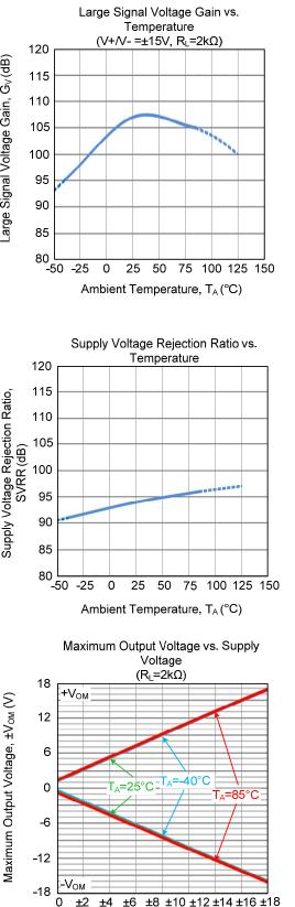
Supply Voltage, V<sup>+</sup>/V<sup>-</sup>(V)
